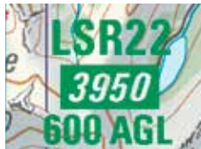
Abb. 1: Beispiel einer LSR for gliders ausserhalb TMA mit einer Untergrenze von 600 Metern über Grund und einer Obergrenze von 3950 Metern über Meer bei Standardatmosphäre.
